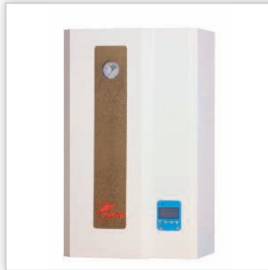
ELTERM, seria GoldLine, elektryczny kocioł centralnego ogrzewania „General”. Kocioł dwufunkcyjny do pracy samodzielnej, zabudowane naczynie przeponowe c.o. 8 l, 2 pompy c.o./c.w.u. oraz armatura hydrauliczna; sterowanie pogodowe, wyświetlacz LCD; wbudowane programowanie tygodniowe oraz programowanie c.w.u. Moce [kW]: 4-24. Waga [kg]: 28. Wymiary (wys./szer./gł.) [cm]: 68/41/27. Cena katalogowa netto [zł]: od 3170.
